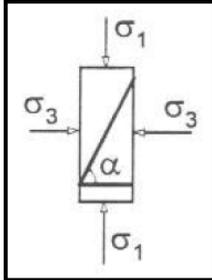
Esquema da câmara de ensaio triaxial.
