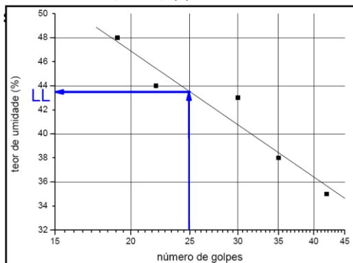
para determinação do teor de umidade. (5) O limite de liquidez é igual ao teor de umidade correspondente a 25 golpes. (6) Realizar o ensaio até que se tenha, no mínimo, 4 pontos, 2 acima e 2 abaixo de 25 golpes.
