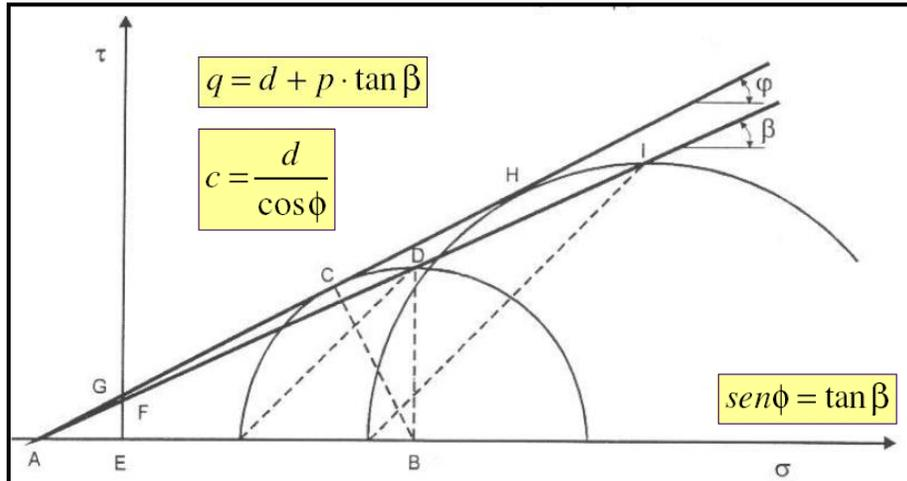
Envoltória de resistência a partir das trajetória de tensões
