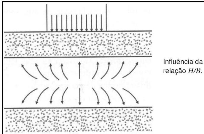
Ilustração do efeito da largura da área carregada e da espessura da camada deformável.
