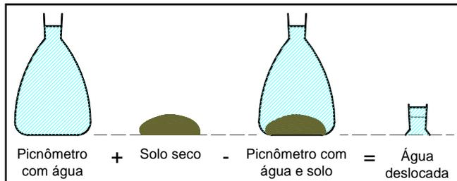
Peso do Picnômetro completado com água, mais o peso do solo, menos o peso do Picnômetro Com solo e água, é o peso da água que foi substituído pelo solo. Deste peso, calcula-se o volume de água que foi substituído do solo.
