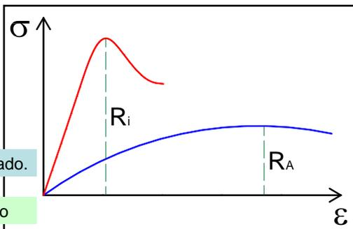
R<sub>i</sub> = Resistência no estado indeformado.
