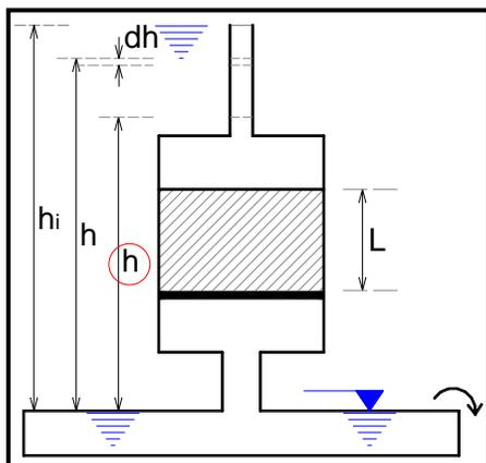
Esquema de permeômetro de carga variável
