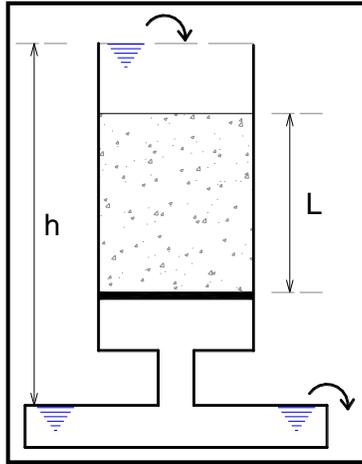
Esquema de permeômetro de carga constante
