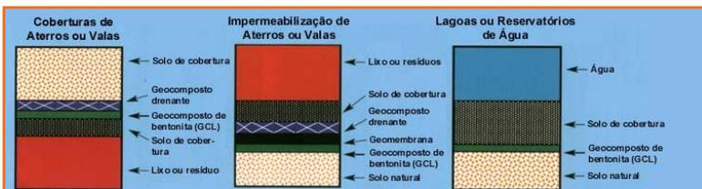
Detalle da aplicação do Geocomposto de Bentonita
