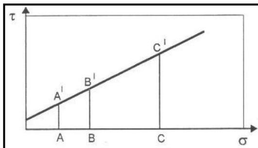
Onde  $\tau_{\max}$  é a máxima tensão de cisalhamento possível no plano (resistência),  $c$  é a coesão,  $\phi$  é o ângulo de atrito, e  $\sigma$  é a tensão normal ao plano.
