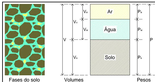
▣ Uso Prático: (a) caracterização das amostras de solo para ensaios de laboratório; (b) verificação do grau de compactação de aterros; (c) cálculo de tensões no solo.
