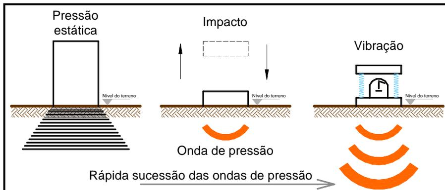
Sistemática dos métodos de compactação no campo ou em laboratório.
