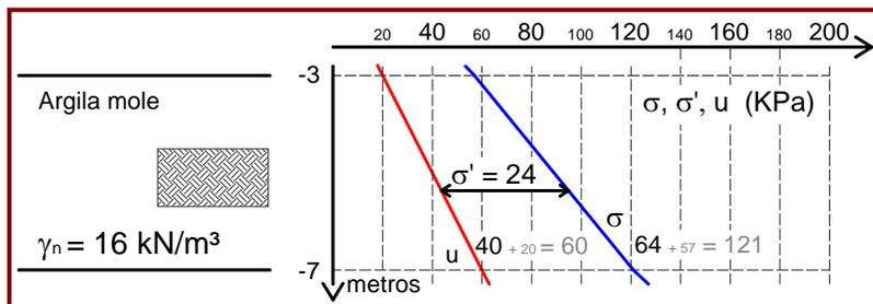
Acréscimo da tensão total:  $\Delta\sigma = \gamma_n \times \Delta_z = 16 \times 4 = 64\text{kPa}$
