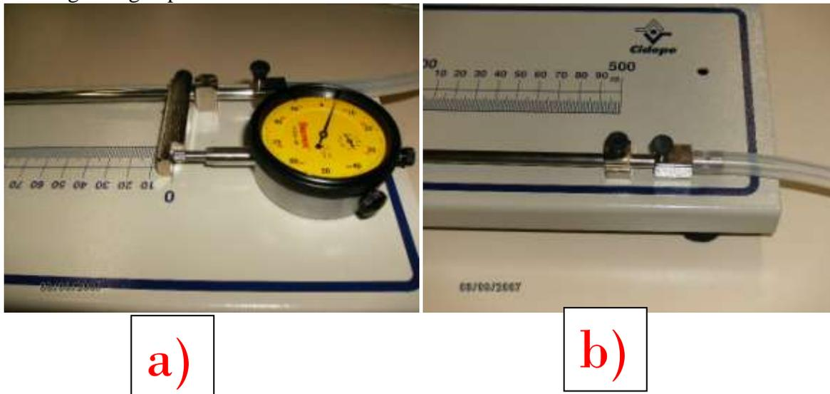
**Figura 1** - Alinhamento do batente e corpo de prova com o relógio marcador (dilatômetro)
