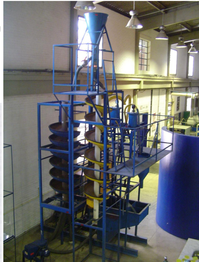
Figura 8.24. Separação de partículas na espiral de Humphreys
