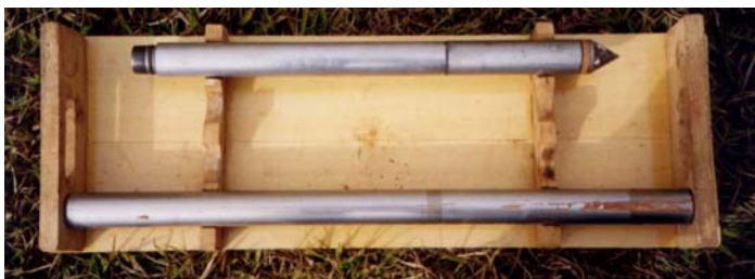
FIGURA 34 - Ponteira Cone-atrito elétrica, utilizada nos ensaios CPT
