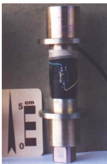
FIGURA 15 - Torquímetro elétrico com capacidade máxima de 50 kgf.m
