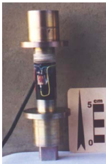
FIGURA 14 - Torquímetro elétrico com capacidade máxima de 20 kgf.m
