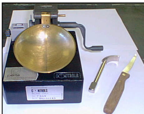
Esquema do aparelho de Casagrande para determinação do LL.
