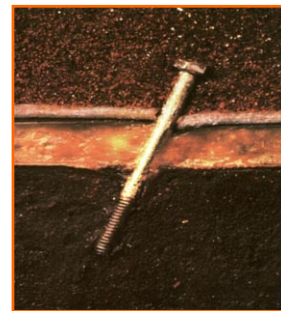
Capacidade de regeneração da bentonita sódica quando perfurada
