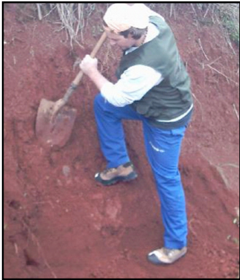
Preparação do solo para extração da amostra indeformada.
