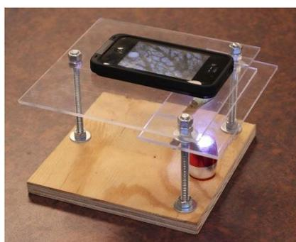
Figura 6: Microscópio finalizado com estrutura sendo focalizada
