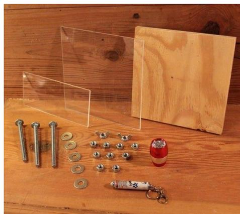
Figura 1: Materiais para montar o microscópio.
