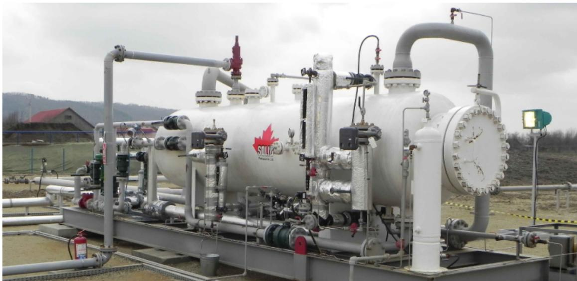
**Figura 2:** Vaso separador trifásico horizontal.
