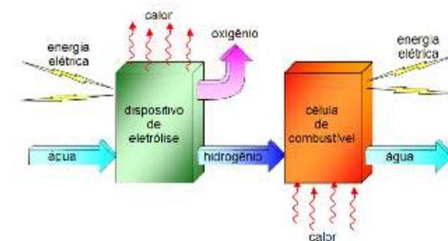
Figura 5.24 - Diagrama esquemático do ciclo de conversões de um sistema de eletrólise e de uma célula de combustível.
