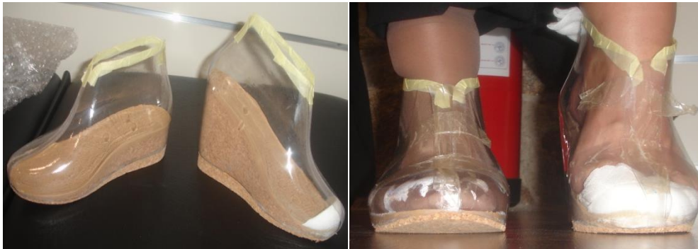
Figuras 23 e 24 - Sapato teste para avaliação de zonas de desconforto e de hiperpressões.
