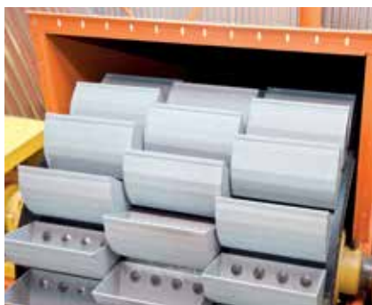
DETALHE DO EIXO, TAMBOR E CANECAS DO ELEVADOR
