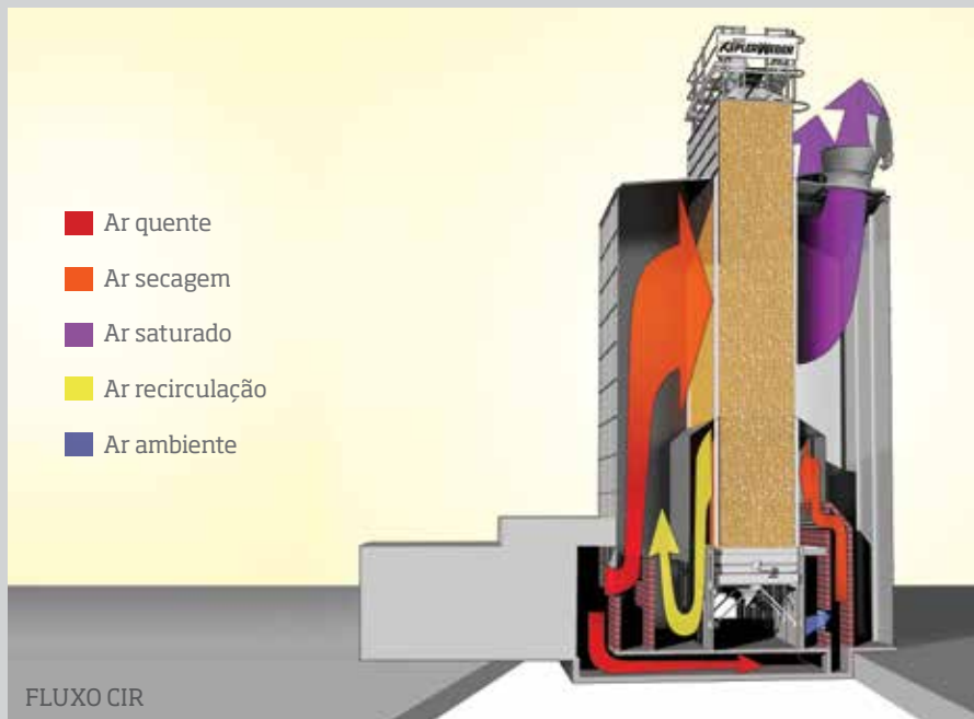
FLUXO DE AR CIR (Coluna inteira recirculado)
